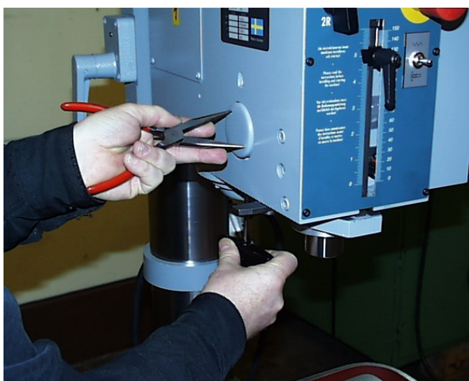
Bild 5. Borttagning av fjäderhus
